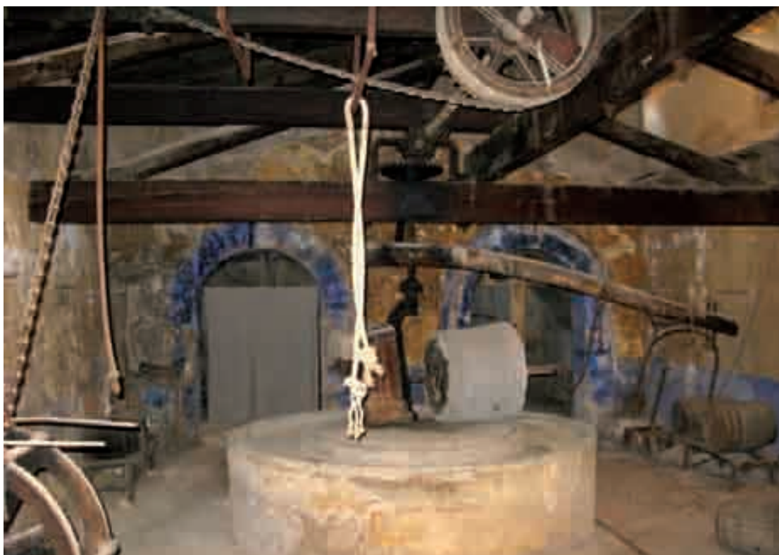
Figura 437. Almazara de la "possessió" de Bendinat, donde se aprecia el molino de sangre y al fondo se aprecian los almacenes.
