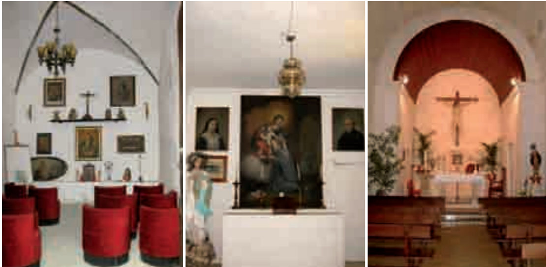
Figuras 427, 428, 429. Disposición interna de algunas de las capillas conservadas. En primer lugar encontramos la capilla de Son Boronat, con cubierta de bóveda de crucería, Son Alfonso con cubierta plana y Santa Ponça, con cubierta de bóveda de cañón.
