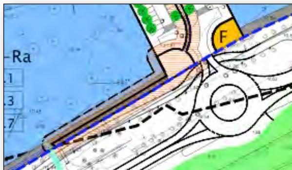
Para destinarla a balsa de infiltración de las aguas del xaragall central se destina una porción de suelo en la zona sur del sector, junto al vial.
