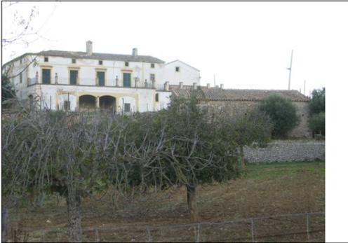
La vivienda tiene tres plantas. La planta tiene un cuerpo adosado de una planta con terraza superior a la que se accede desde la planta noble. Frente a la vivienda un cuerpo de planta longitudinal con cubierta inclinada de una vertiente. El cuerpo de la planta baja tiene un porche que abre en la parte frontal con dos arcos escarzanos
