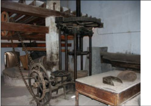
Prensa mecánica con cuatro columnas y esportinador móvil.
