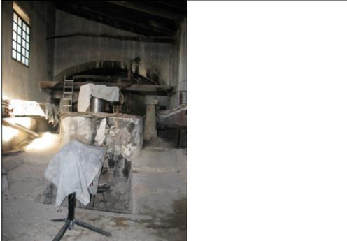
Descripción: Prensas de viga que conservan todos sus elementos. En la viga de la derecha hay una inscripción que la data en 1897. El suelo está en pendiente, que se salva mediante la construcción de escalones en la zona central
